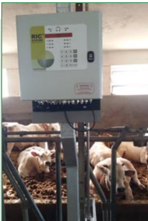
La centralina RIC SYSTEM riconosce l'animale e ne registra il consumo di foraggio
